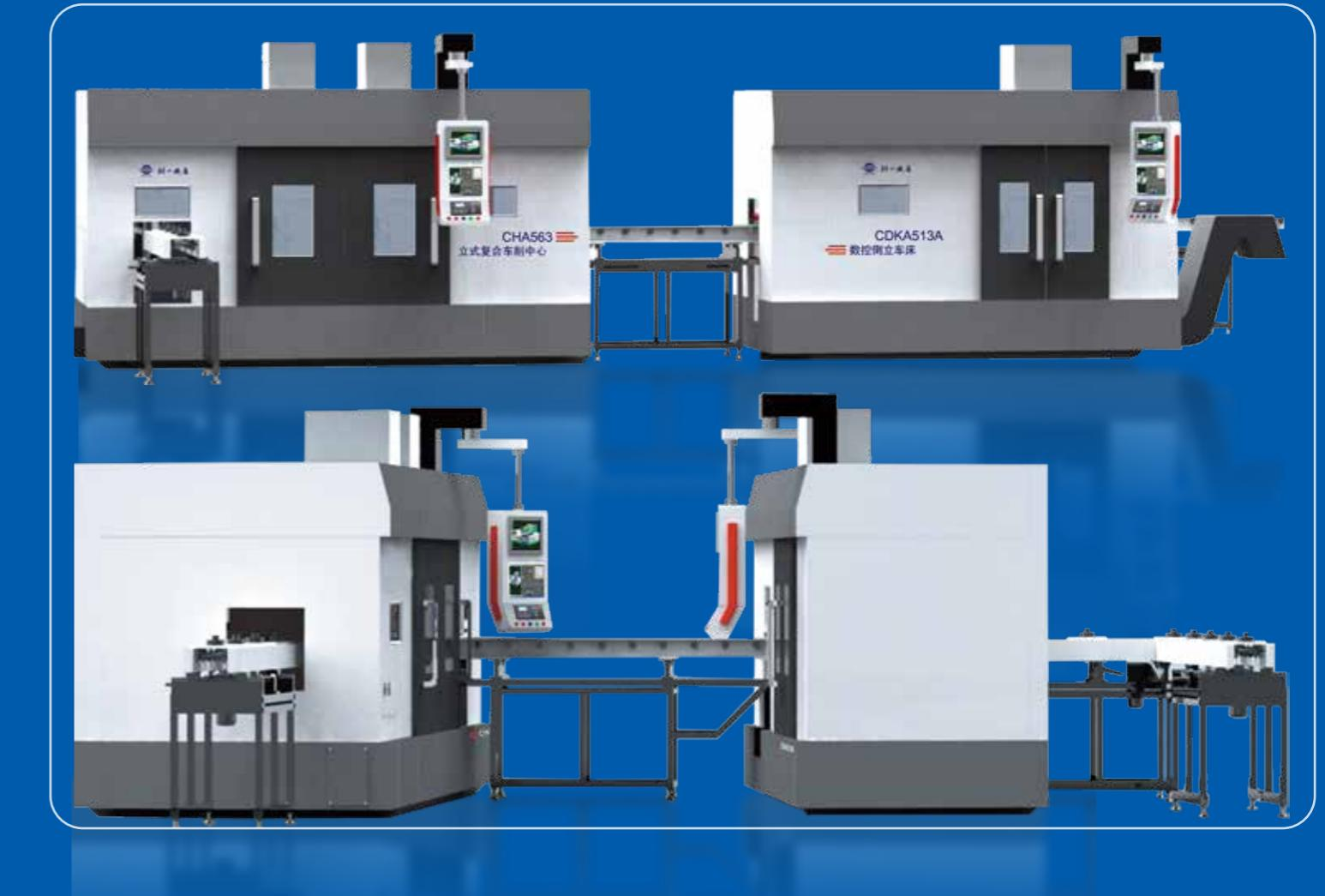
B1-ZX001汽车零件加工生产线具有高精度、高效率、高可靠性和高柔性的特点，能够实现刹车盘自动装夹，完成粗车、精车、铣削、钻孔、攻丝、镗孔、双面车、双面磨，并采取多项物流机构上工件位置的可靠性检测手段，实现了工件从毛坯到成品的全自动化加工过程。该生产线由1台CHA563立式复合车削中心、1台CDKA513A数控倒立车床和1套自动化物流传送机构串联组成，可以满足目前市场上流行大部分刹车盘加工的需求。将来，在物流机构上增加上料、下料机械手后，可以实现整个加工过程无人化操作，满足现代化加工的需求。
